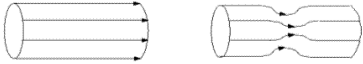
Abbildung 9.2: Bei der Kontraktion einer Plasmasäule erhöht sich der magnetische Fluss
